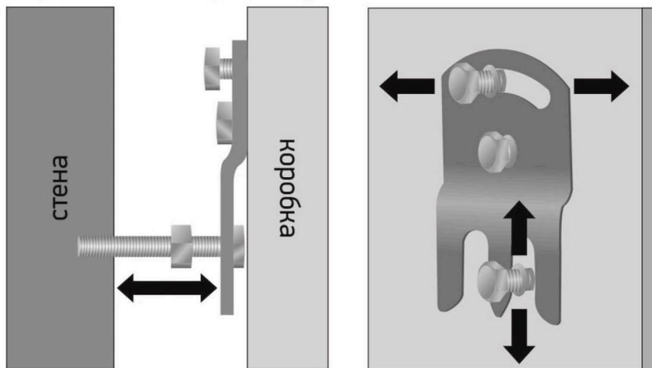
ослаблением гаек болтов, а при необходимости также шурупов №1 и №2, с последующей их затяжкой. Технические возможности кронштейнов МКС также позволяют исправлять при установке такие дефекты коробочного бруса, как изгибы. Для этого необходимо ослабить шурупы и гайку в нужном месте, надавить на коробку (прогнуть ее) вглубь или наружу проема, затем снова зафиксировать кронштейн шурупами и гайкой.
