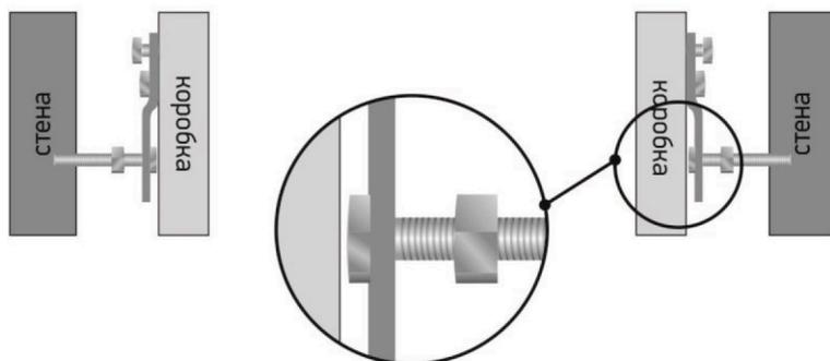
**8.** Коробку с установленными кронштейнами поместить в проем, движением сверху-вниз опустить ее на отрегулированные болты, добиваясь входа всех болтов в пазы кронштейнов. Выровняв коробку относительно стены или по уровню, затяните шурупы в точках №1 и №2, а также гайки болтов. Если после установки дверного полотна требуется корректировка зазоров или всего дверного блока относительно проема, то регулировка осуществляется следующим образом:
