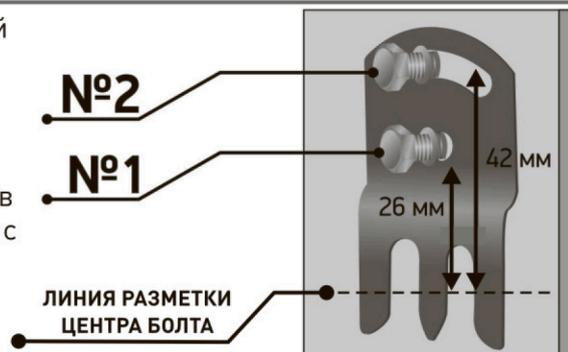
**7.** Расстояние между шляпками противоположных болтов в стене и ширина коробки должны быть одного размера. Рекомендуется установить размер между болтами верхней пары, и затем с помощью уровня или отвеса выставить все нижние.
